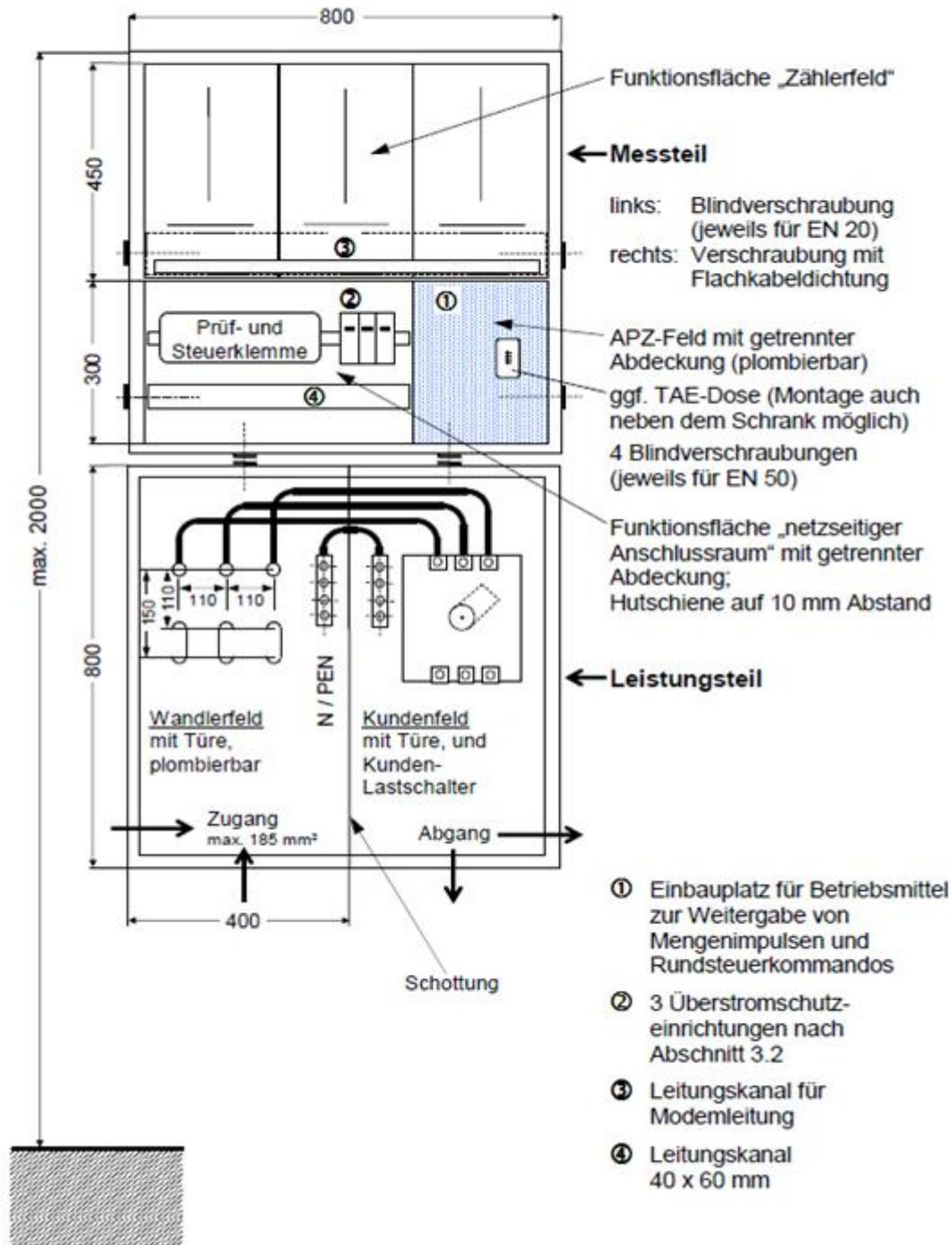
**Abbildung:** Prinzipieller Aufbau einer halbindirekten Messung (Wandlermessung) bis 250
