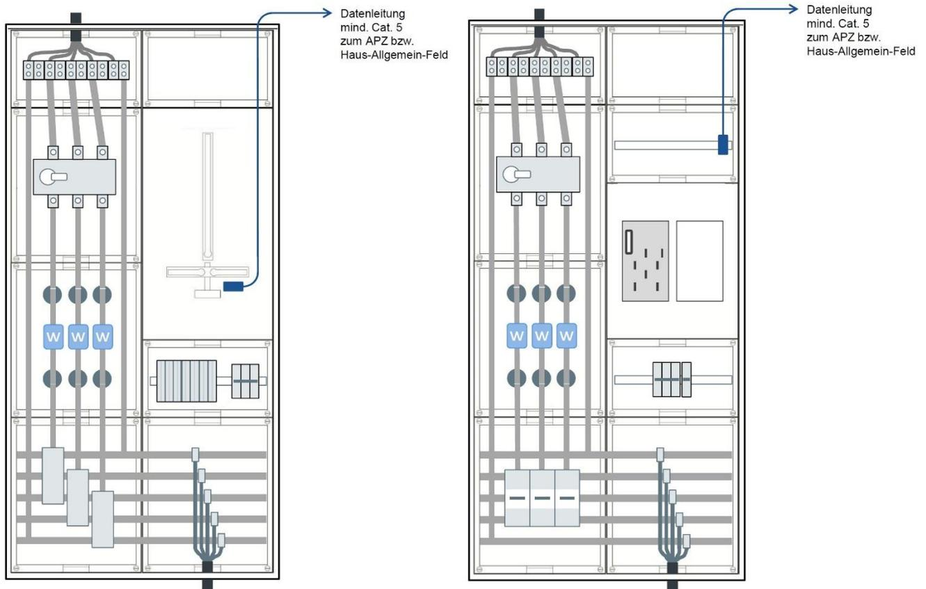
**Abbildung:** Prinzipieller Aufbau einer halbindirekten Messung bis 100 A.
