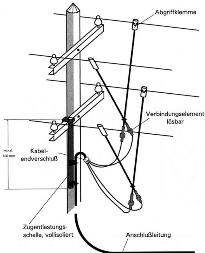
**Abbildung:** Anschlusselemente für Freileitungsanschluss nach DIN VDE 0680-3
