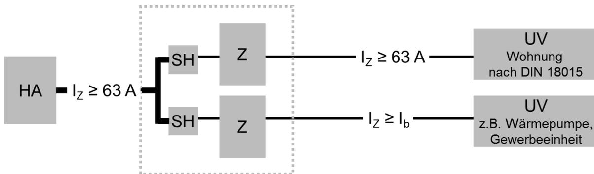
**Abbildung:** Mindestbelastbarkeit von Hauptleitung und -Abzweigen
